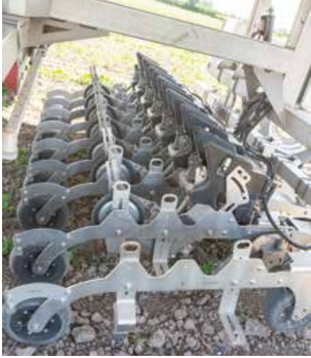
Modellen med fire hjul og syv rækker er egnet til at luge på bede.
