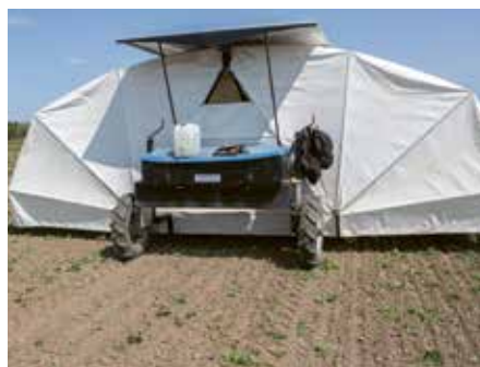
Peter Bay supplerer markrobotten med et lugehold på en lugevogn med solceller.
