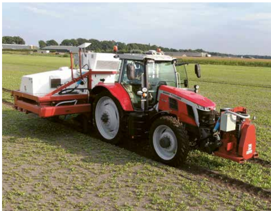
Carbon Robotics Laserweeder under en demonstration i Holland i september 2023. Forrest er generatoren, der drives af en PTO og bagpå selve det liftophængte redskab.
