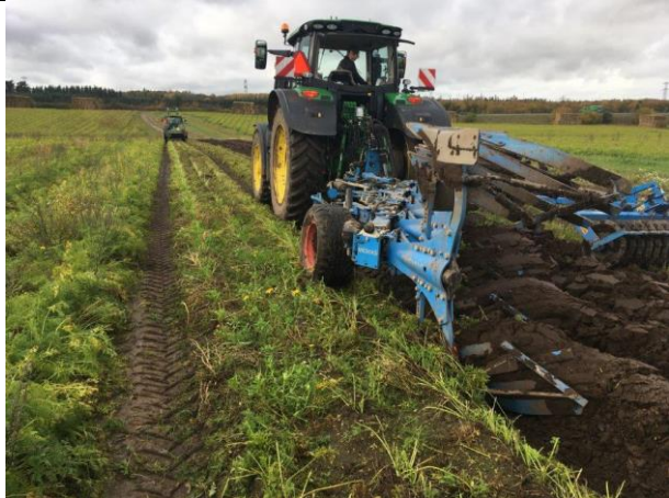
Nedpløjning af gulerødder i bede med 3 rækker. Det fungerer ikke optimalt med en 5-furet plov uden modifikationer. Bærehjulet kører på næste række.
