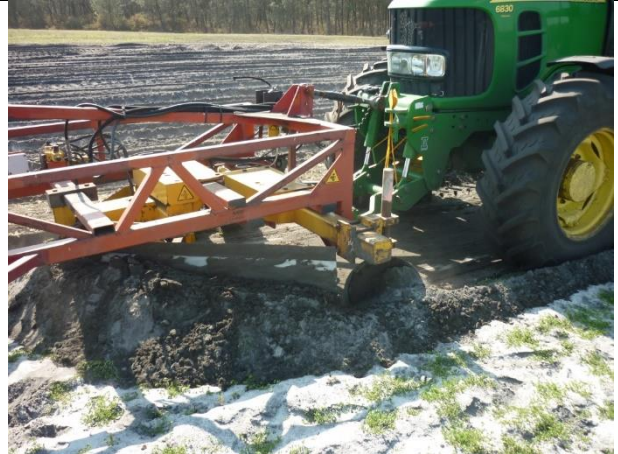
Alternativt en stor plov som skubber de øverste 10 cm jord til siderne.
