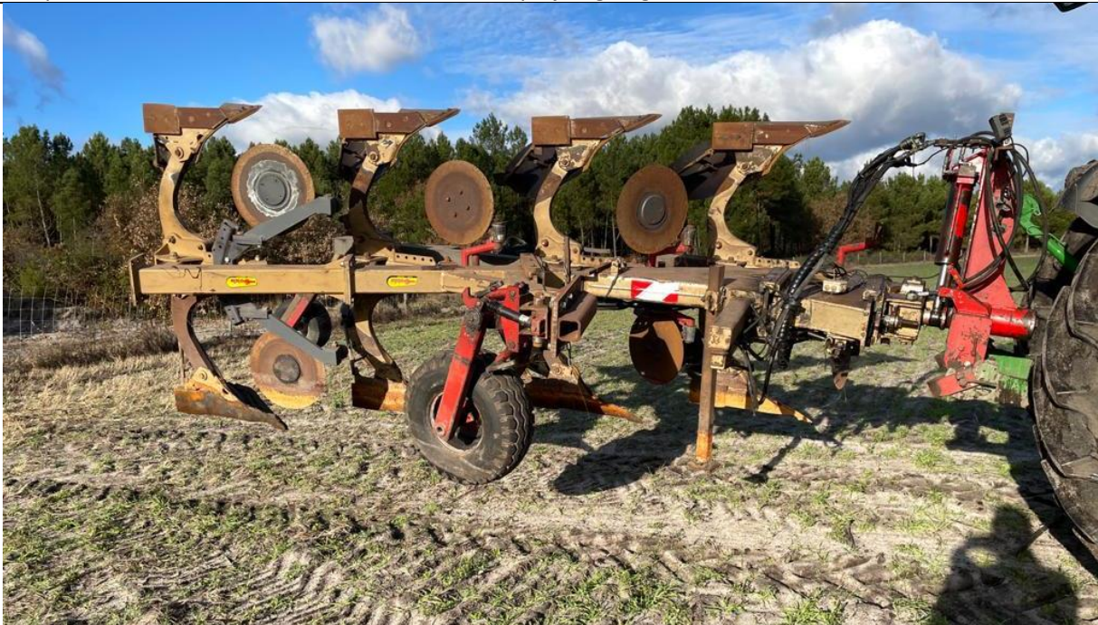
Firefuret plov til nedpløjning af bede med tre rækker gulerødder.
