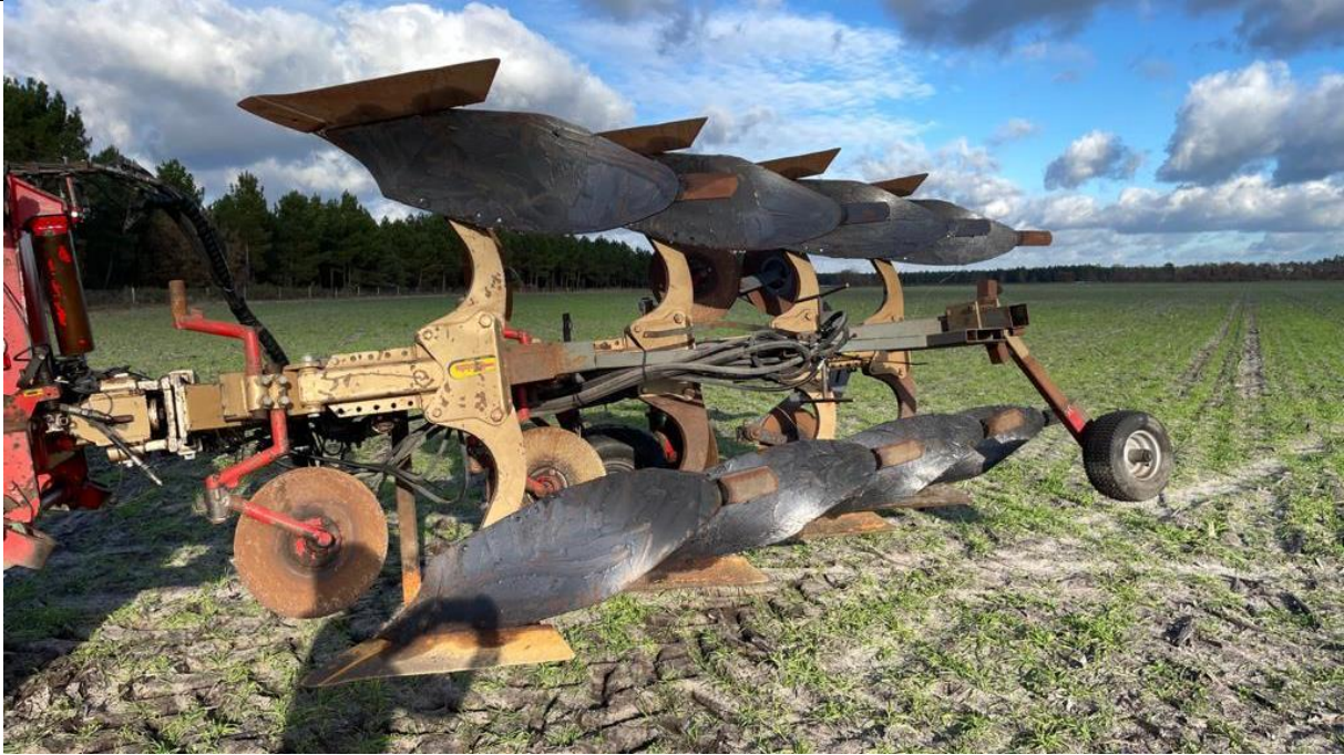
Bedplov fra Bordeaux som er modificeret til nedpløjning af gulerodder.
