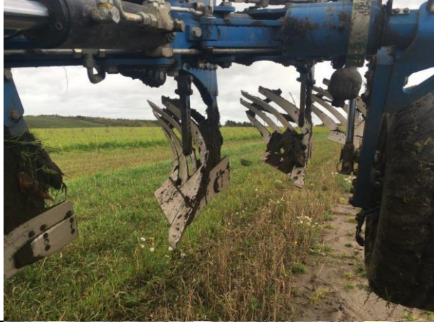
Nedpløjning af gulerødder i bede med 3 rækker. Det fungerer ikke optimalt med en 5-furet plov uden modifikationer. Bærehjulet kører på næste række.
