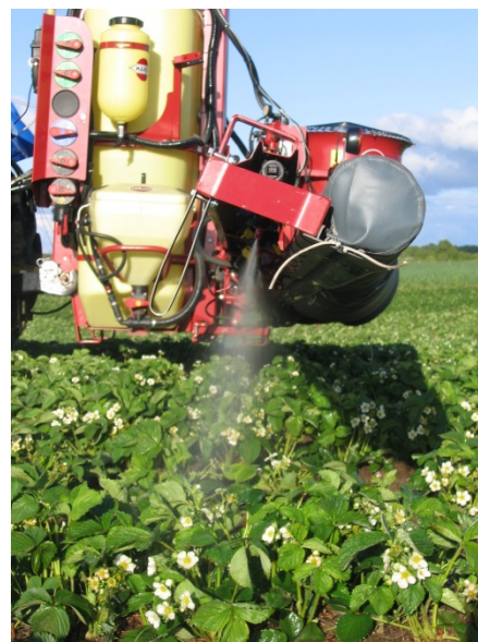
Foto 1 På marksprøjter er luftassistance meget benyttet. Ved korrekt indstilling kan afsætning på undersiden af planterne øges.
