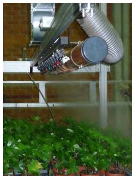
Foto 2 Her ses en prototype på en sprøjtebom med luftassistance fra Belgiske forsøg.
