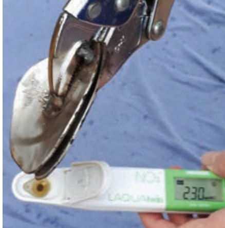
Plantesaftmålinger og forskellige pressemetoder med Laqua Twin NO3.
