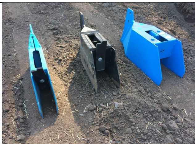
Tre typer såskær afprøvet i forsøg som er hhv 30, 65 og 100 mm i bredden.
