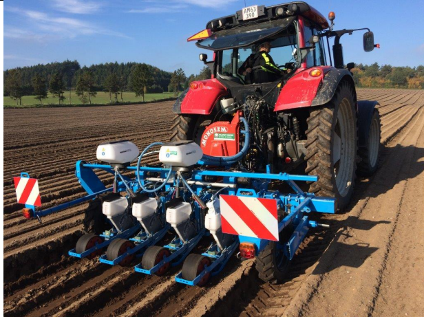
Gulerødderne er sået med en special-konstrueret såmaskine hvor udsædsmængden reguleres elektronisk.
