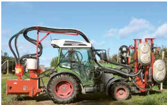
Maskinen til afløvning fra det italienske firma Olmi blæser til begge sider.
