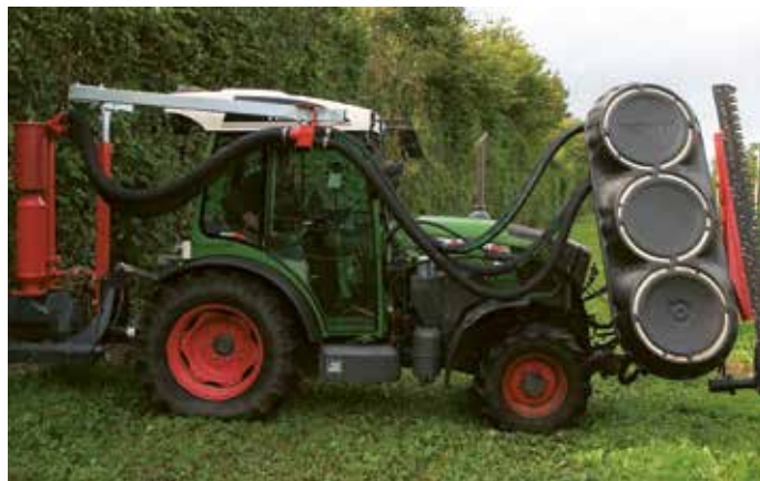
De roterende dele på REDpulse fra det tyske firma Fruit Tec er dækket, så frugten ikke er i berøring med dem og dermed ikke bliver revet af eller får skader.
