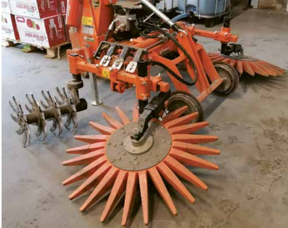
Den italienske maskine Rinieri til mekanisk ukrudtsbekæmpelse fås både med rulleharve og stjerne rullerensere.
