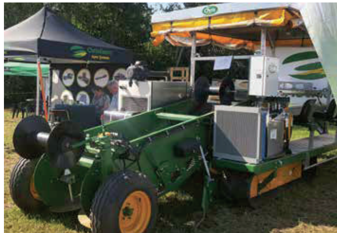
Agro Christiaens forslag til en simpel totalhøster af asparges. Her en version, der høster hvide asparges ved at gennemskære hele kammen i bunden og samle korte og lange skud op. Der findes også en maskine til grønne asparges.
