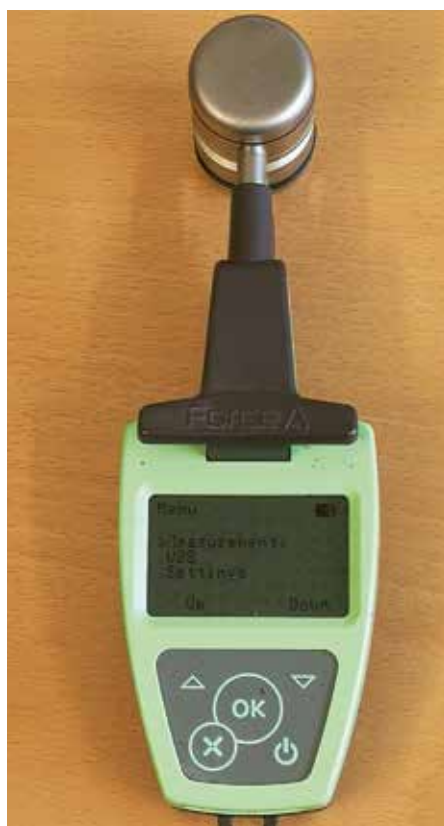
Dualux Scientific er et håndholdt måleapparat, der kan måle farvestofferne klorofyl, flavonoider og anthocyanider i blade.
