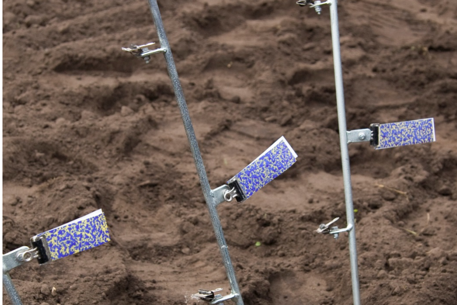
Brug af vandfølsomt papir giver et godt billede af dråbestørrelse og dækning af afgrøden. Foto Stig F. Nielsen.
