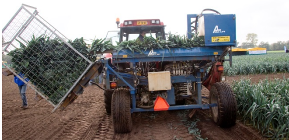
En-rækket ASA-Lift porreoptager, hvor porrerne fyldes i metalbure. Foto: Stig F. Nielsen.
